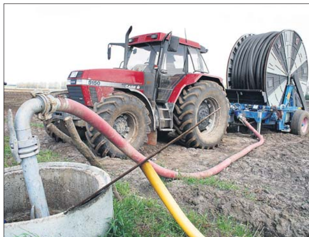
Je größer der Rohrdurchmesser, desto geringer die Fließgeschwindigkeit. FOTO: SABINE RÜBENSAAT
